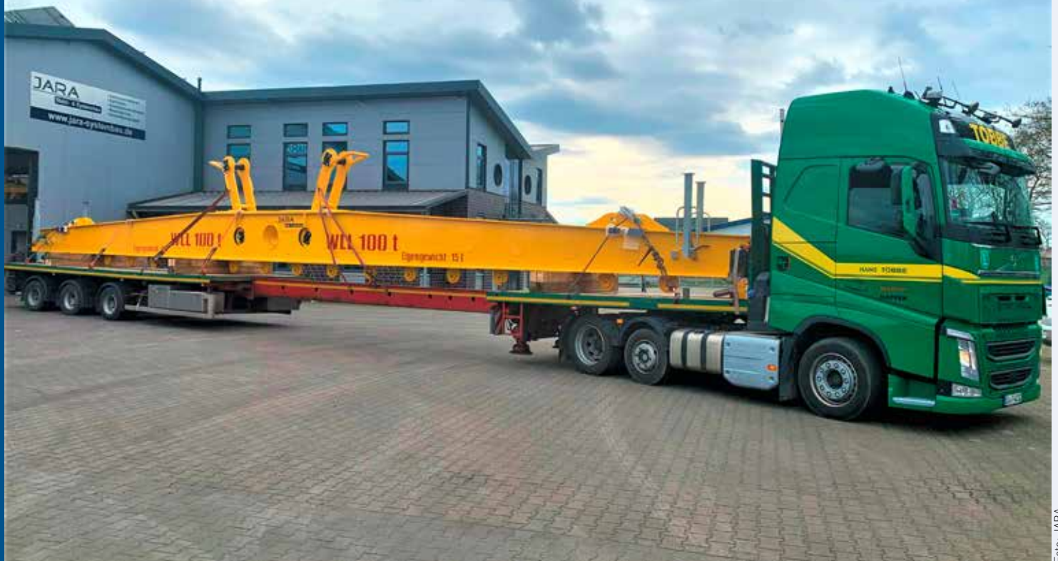
Das JARA-Team hat eine 21 Meter lange und 15 Tonne schwere Traverse für eine Werft gefertigt.
